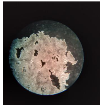
Irudia 13: PLLA polimeroaren euskarria, 4,8 g gatzekin nahastua, molde handian. Mikroskopia optikoa erabiliz.
