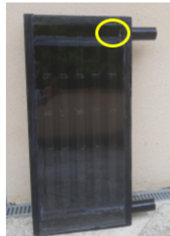
Argazkia 12: tenperatura kolore hori adierazitako puntuan hartu da
