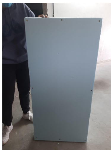
Argazkia 7: Piezak torlojuarekin finkatuta Bideoa 2: piezak silikona txuriarekin itsasten
