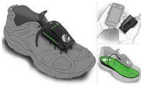
Irudia 2: energia elektrizitate bihurtzen duen oinetako barne-zola
