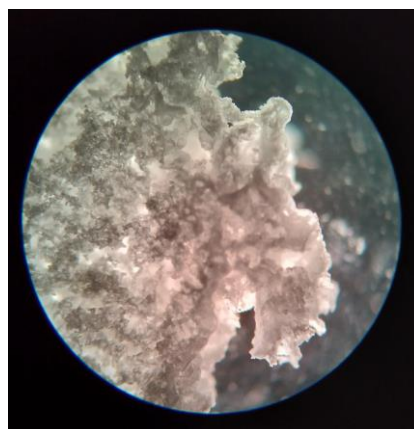
PCL-a, mikroskopia optikoan ikusita
