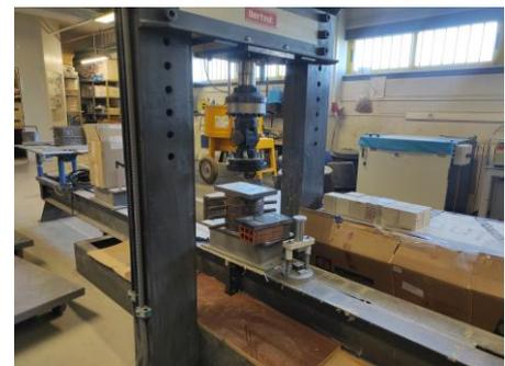
Después de romper una pequeña muestra de ladrillo en una máquina de *Ensayo Universal*, con una fuerza de 10KN, comenzamos el ensayo con el Micelio.
